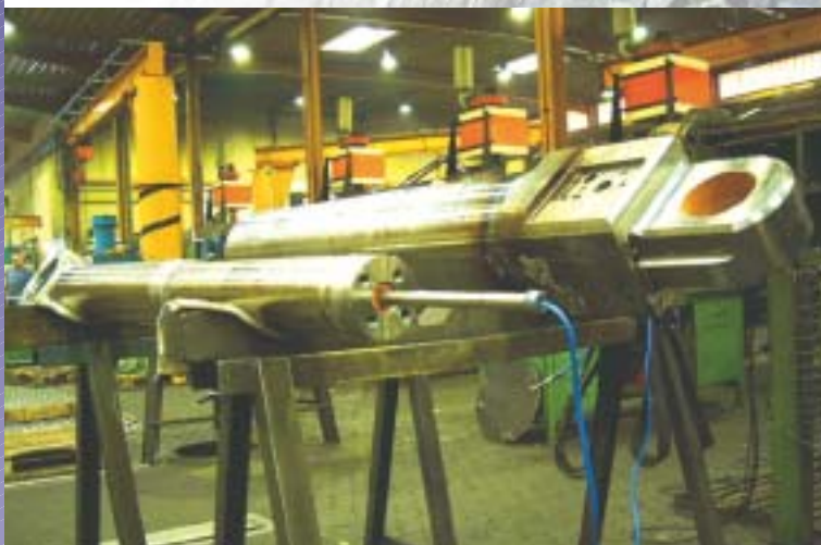
Montage des Wegmessstabes in einen Tragarm-Hubzylinder
