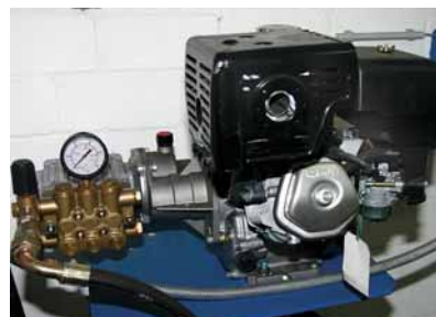
Dieselmotor plus Pumpe: Notaggregat für den Kippzylinder.
