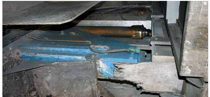
Hitzeschutz für Leitungen: Wegen der Hitze kommen in der Gießerei elektrische Leitungen mit Hitzeschutzschläuchen zum Einsatz. Bilder: nf
