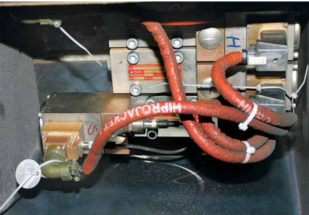
Hitzeschutz für Leitungen: Wegen der Hitze kommen in der Gießerei elektrische Leitungen mit Hitzeschutzschläuchen zum Einsatz. Bilder: nf
