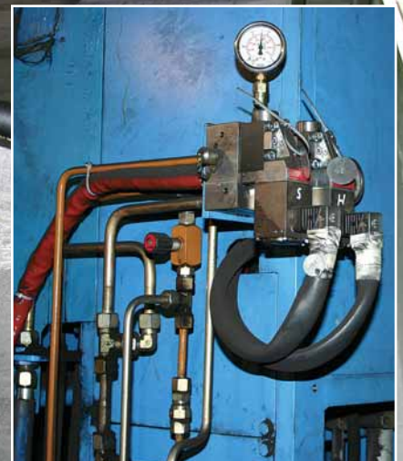
Zwei-Zwei-Wegeventil plus 120er Zylinder: sorgen für das Kippen des Ofens.
